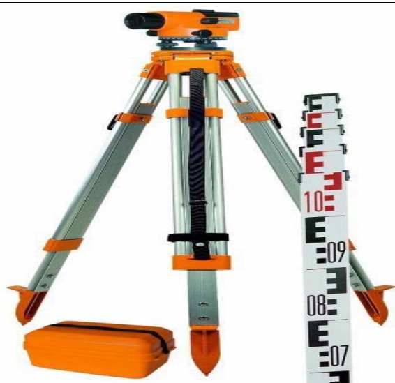
Рис. 11 Технический нивелир на штативе и нивелирная рейка
