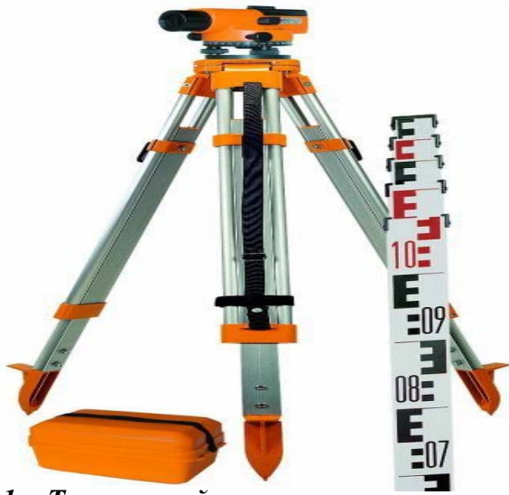
Рис. 11 Технический нивелир на штативе и нивелирная рейка
